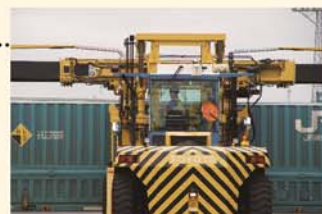
貨車にコンテナを積みおろしするトップリフターという機械。オペレーターには高度の操縦技術が要求される。
