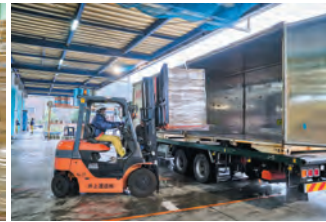
12ftコンテナへパレット積み
