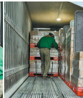
養生材を入れながら積んでいく
