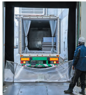
冷凍コンテナをドックに接岸する
