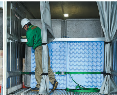
ラッシングバーを取り付ける
