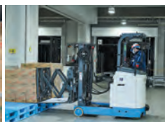
プッシュボタンフォークリフトでシートパレットをつかみ、パレットへ
