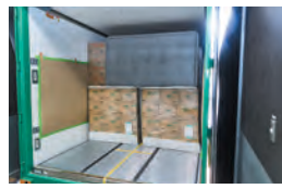
養生材はトラックと共通 下段にはL字ガード
