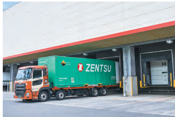
ドックシェルターに接車した31ftオートフロアコンテナ
