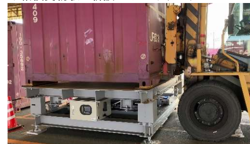
◆相模貨物駅に新設したコンテナスケール
