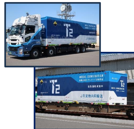
◆トラック及び鉄道の双方で輸送可能なスワップボディコンテナ
