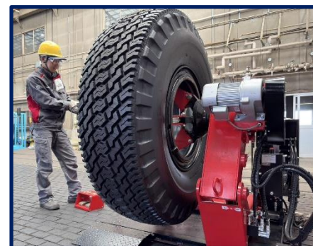
◆内製化したタイヤ組立作業の様子 (東新潟機関区)
