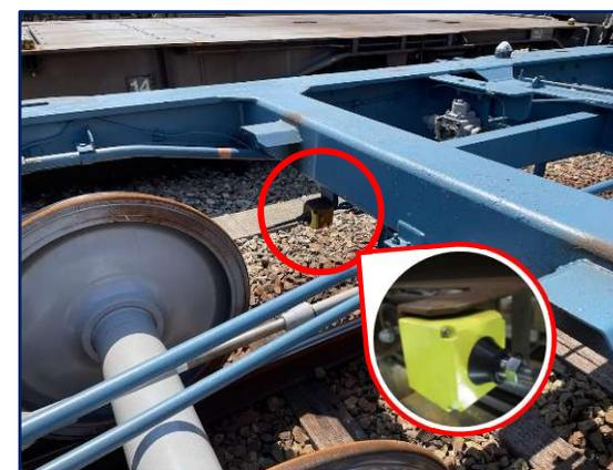
◆コンテナ車に設置されている手ブレーキ検知装置
