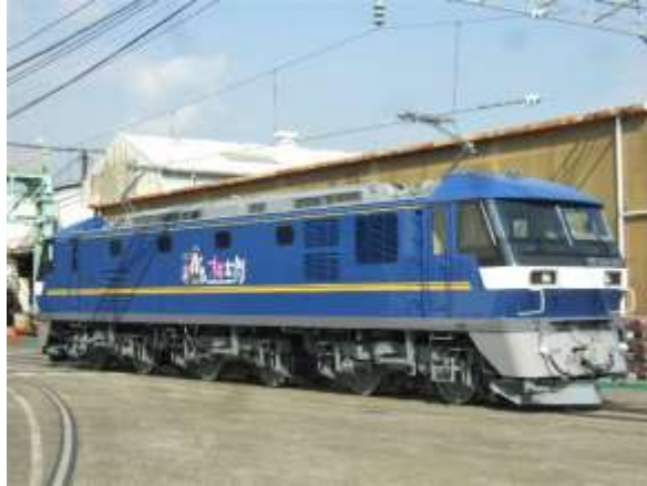
導入車両：EF210形式直流電気機関車「ECO-POWER 桃太郎」 （主な運行線区 東北線、高崎線、東海道線、山陽線、予讃線）
