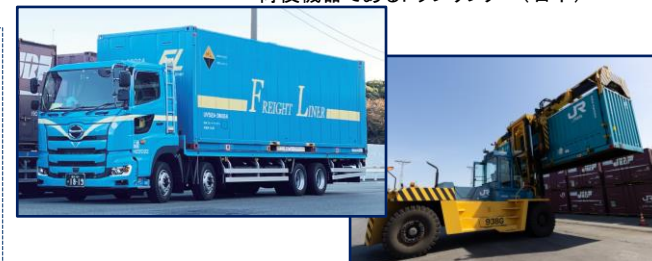
◆拡大を図る31ftコンテナを積載したトラック(左下)と荷役機器であるトップリフター(右下)
