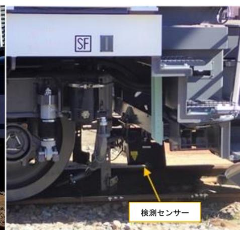
写真-2 検測センサー取付状況
