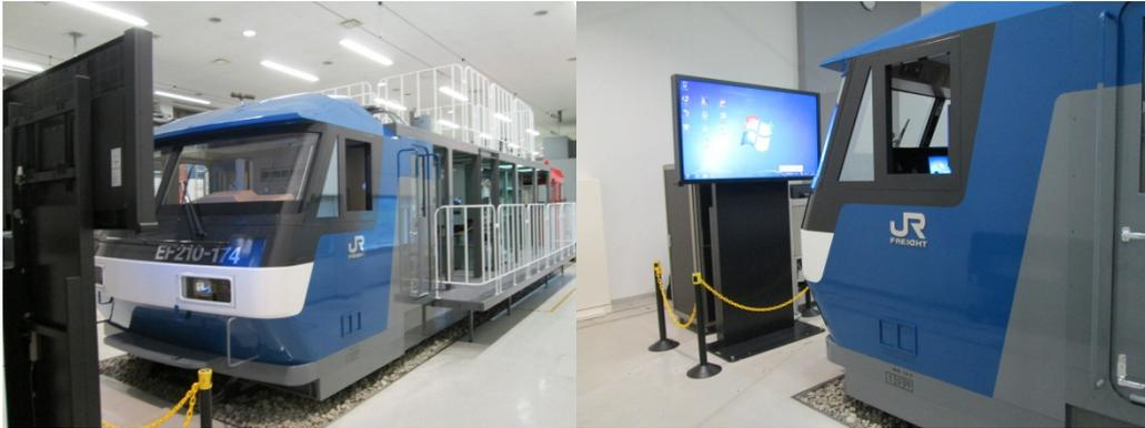
(写真1) EF210形式直流電気機関車運転シミュレータ
