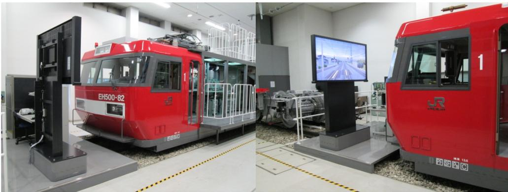
(写真2) EH500形式交直流電気機関車運転シミュレータ
