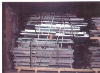
改善前(金属製品の荷崩れ)
