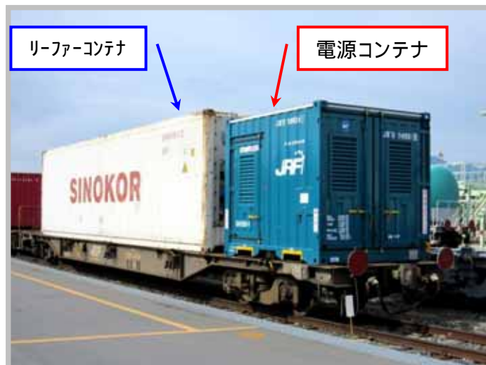
(写真2)リーファーコンテナ用電源コンテナ
