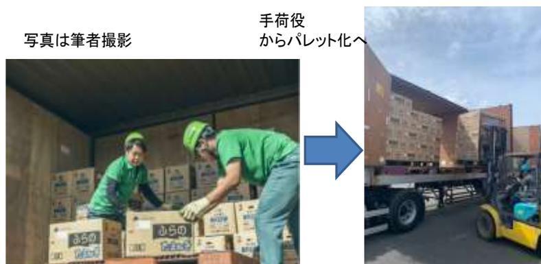
図8 手積とパレットによる機械荷役
