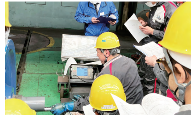
「輪軸研修」での超音波探傷検査実習
