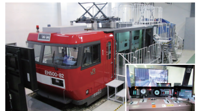
EH500形式電気機関車シミュレーターと運転台
