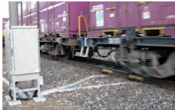
輪重測定装置による測定
