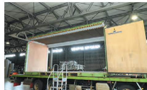
両側と屋根の一部が開閉するUV36Aコンテナ
