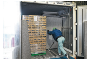
養生材を入れながら奥へ送り込む
