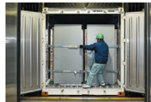
ラッシングベルトで固定する
