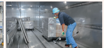
ジョロダールで製品をコンテナの奥へ
