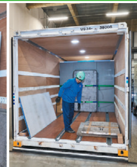
緩衝材で養生しラッシングベルトで固定する。この後別倉庫でさらに食品包装容器を積載して名古屋(タ)へ
