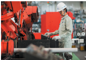
注文の寸法にパイプを切断
