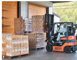
荷揃えた製品を両面から3パレットずつコンテナへ
