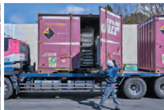
扉を閉め封印環を付ける
