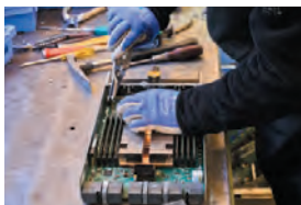
人手による解体作業
