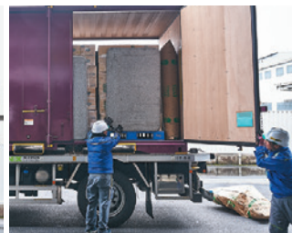
養生材を入れて閉扉する
