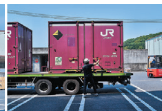
閉扉して封印環を付ける
