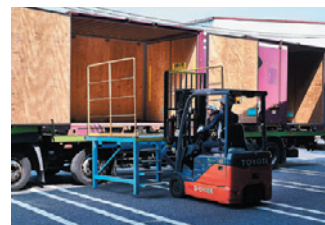
安全に積み付けるため作業台を設置
