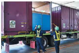
養生材を挟みながら閉扉する
