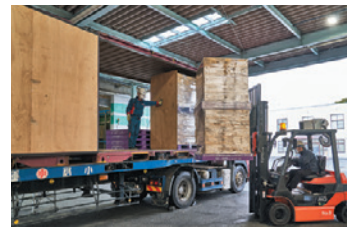
ラッシングボードを挟んで崩れを防ぐ
