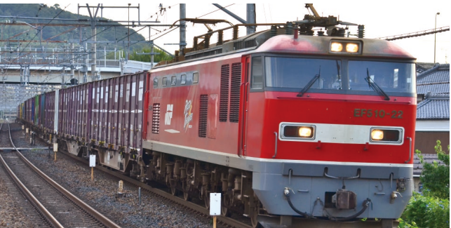
EF510形式交直流電気機関車「ECO-POWERレッドサンダー」
