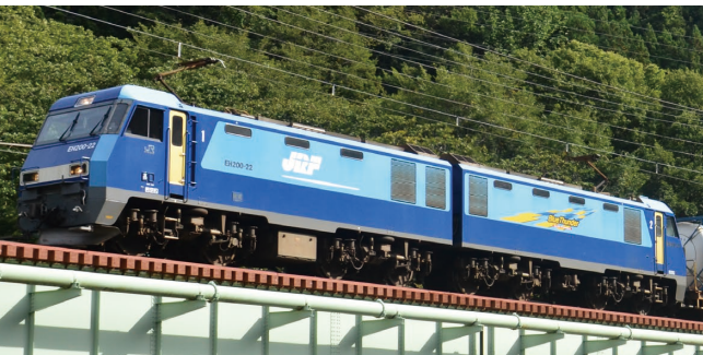
EH200形式直流電気機関車「ECO-POWERブルーサンダー」
