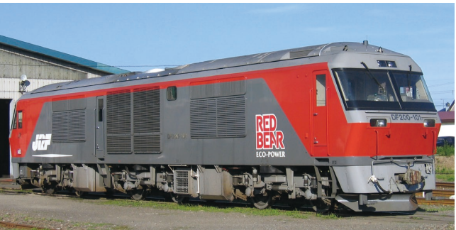
DF200形式電気式ディーゼル機関車「ECO-POWERレッドベア」
