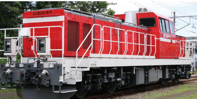
DD200形式電気式ディーゼル機関車
