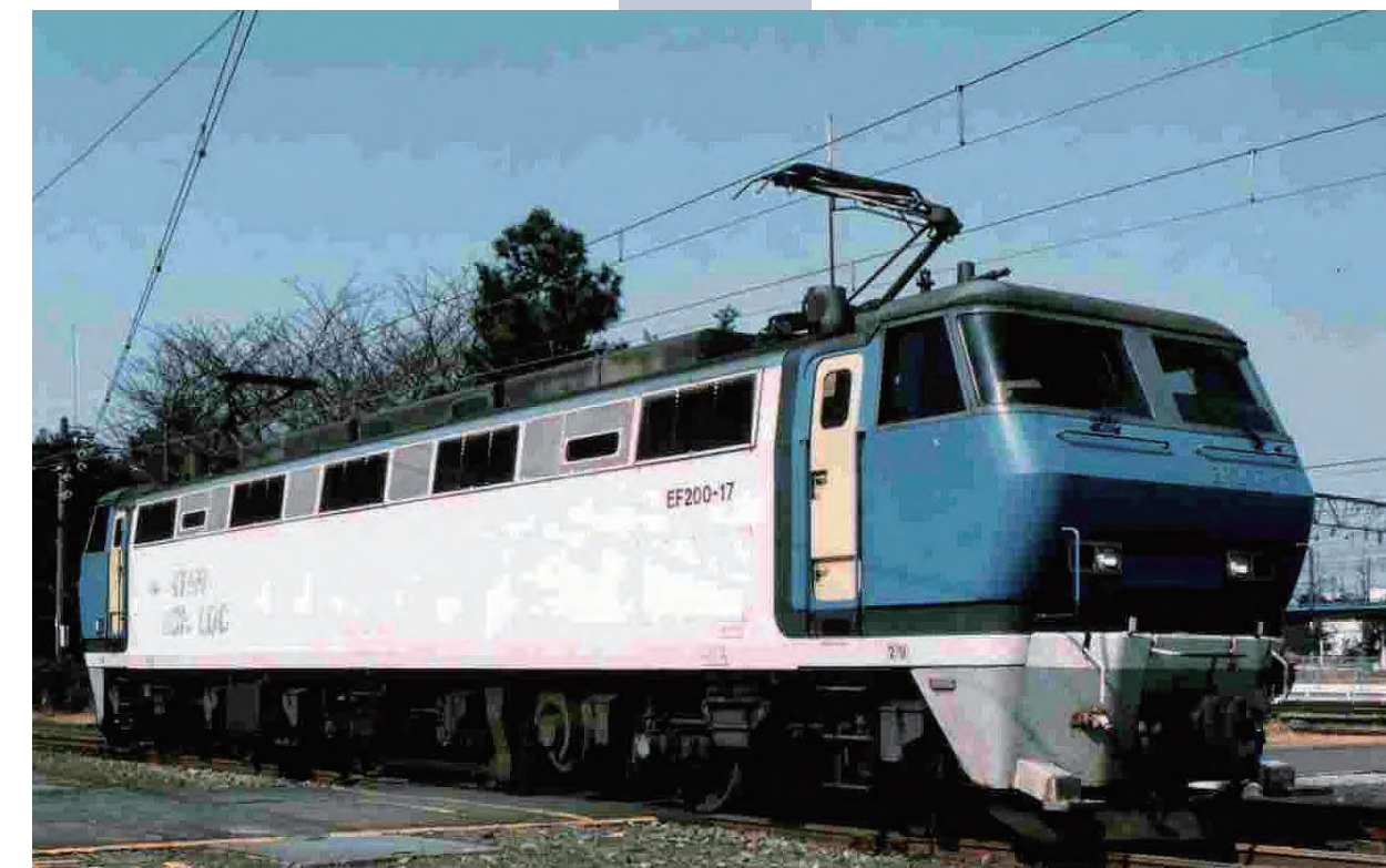
1990年6月19日 JR貨物発足後、初めて新形式となる電気機関車(EF200形式)が完成(初のVVVFインバーター制御)
