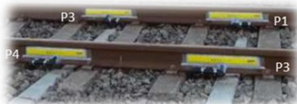
輪重測定装置
