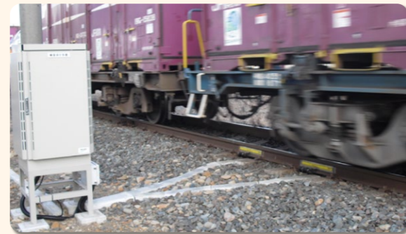
輪重測定装置による測定
