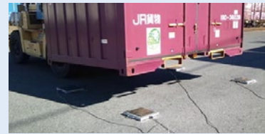
12ftコンテナの脚部4カ所の重量を計測
