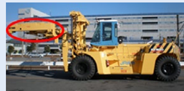
トップリフターのスプレッド部で4点の重量を測定
