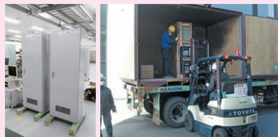
列車集中制御装置 (CTC) と、鉄道コンテナへの積み込み作業
