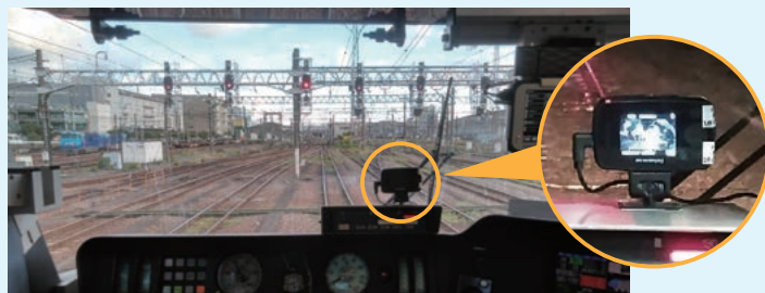
ドライブレコーダーの設置
