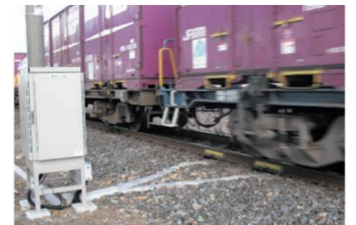
輪重測定装置による測定
