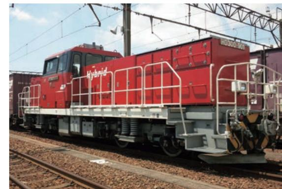
貨物駅構内での貨車入換作業における環境負荷低減のため、小型ディーゼルエンジンと大容量リチウムイオン蓄電池を組み合わせたシリーズ式ハイブリッド機関車HD300形式を開発し導入しています。環境性能を既存の入換機関車と比較すると、燃料消費量36.0%低減<sup>※1</sup>、窒素酸化物(NOx)排出量61.4%低減<sup>※1</sup>、騒音レベル22dB低減<sup>※2</sup>を各々実現しています。2010年に試作車、2012年に量産1号機、2014年に寒冷地仕様車(500番代)を導入し、2022年4月1日現在、全国の支社管内の各駅で41両運用し、貨物駅における入換機関車として環境負荷の低減を実現しています。
