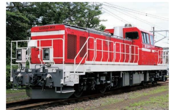
橋梁強度が低い線区にも入線可能な本線・入換兼用ディーゼル機関車の置換を目的に、DD200形式電気式ディーゼル機関車を開発し、導入しています。環境負荷軽減に配慮し、エンジン排出ガスレベルは第2次規制相当で、インバータ装置には電力変換効率が高いハイブリッドSiC(シリコンカーバイド)素子を適用しました。置換前の機関車と比較して、燃料消費量20.3%低減<sup>※1</sup>、窒素酸化物(NOx)排出量18.6%低減<sup>※1</sup>、騒音レベル11dB低減<sup>※2</sup>を実現しています。
