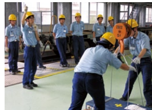
玉掛(大きな部品を上からつるして移動するための合図を行う作業)
