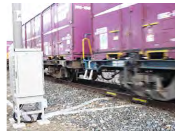
走行中の貨車の輪重比を測定する輪重測定装置
