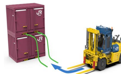
フォークリフトへの ガイダンス・セミオート機能の導入 © Japan Freight Railway Company
