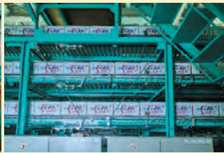
光センサー選果機により、大きさや形、着色の程度や糖度、蜜入りなど、それぞれの規格に分けられ、箱詰めされる
