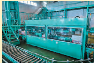
光センサー選果機により、大きさや形、着色の程度や糖度、蜜入りなど、それぞれの規格に分けられ、箱詰めされる
