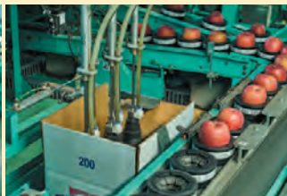
光センサー選果機により、大きさや形、着色の程度や糖度、蜜入りなど、それぞれの規格に分けられ、箱詰めされる
