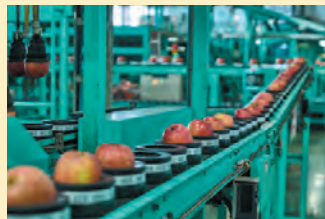
光センサー選果機により、大きさや形、着色の程度や糖度、蜜入りなど、それぞれの規格に分けられ、箱詰めされる
