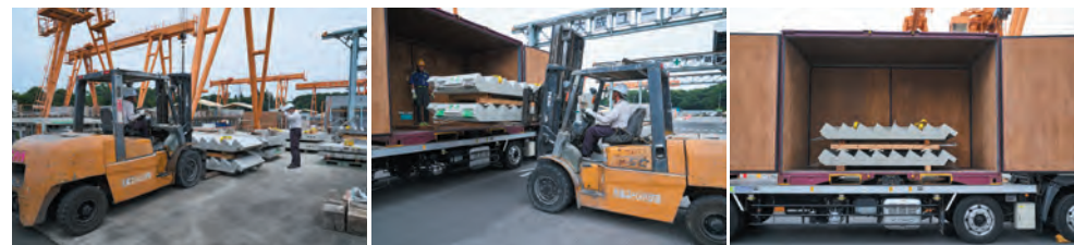
ストックヤードに置かれた階段板をコンテナに積み込む
