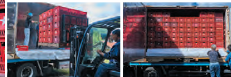
積み込み後、吸水シートを扉の内側に折り返す
