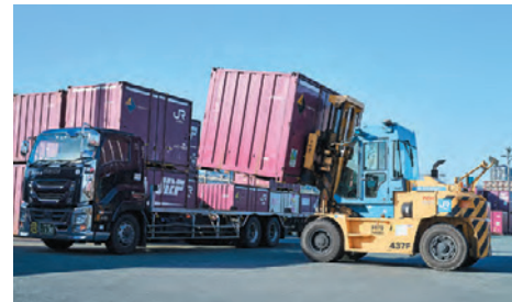
隣接するコンテナホームに降ろす
