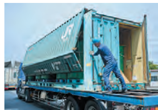
鹿島臨海倉庫に到着した31ftコンテナの両サイドから製品を取り卸す
