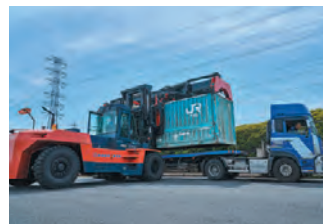
トップリフターで鹿島臨海通運のトラックからコンテナ車へ積み替える 神栖駅コンテナホームで
