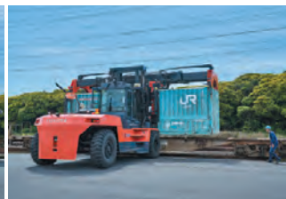
トップリフターで鹿島臨海通運のトラックからコンテナ車へ積み替える 神栖駅コンテナホームで
