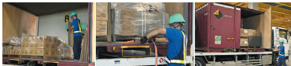
荷崩れ防止にパレットの間にボードを挟み、ラッシングベルトで固定
