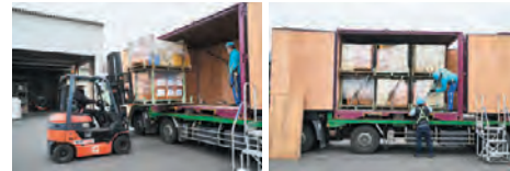
信和工業向け通函を積みラッシングベルトを掛ける
