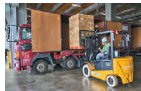
バースで12ftコンテナへ積載する
