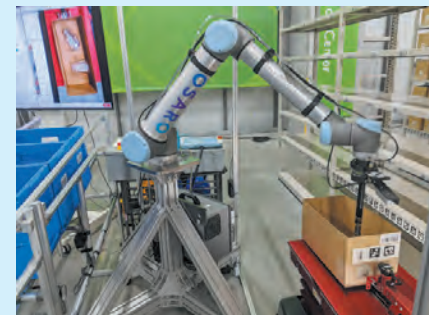
ピッキングロボットとAMR(自律走行搬送ロボット)の連携による倉庫自動化オペレーションの共同実験検証の様子
